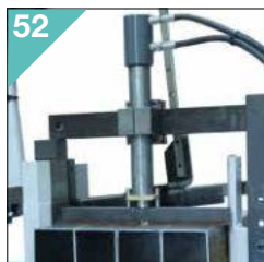
52 Hydraulické zařízení pro řezání ve svazku Hydraulic device for bundle cutting.
