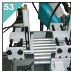
53 AUTOMATICHE SERIE BS - AUTOMATIC BS SERIES Hydraulické zařízení pro řezání ve svazku Hydraulic device for bundle cutting.
