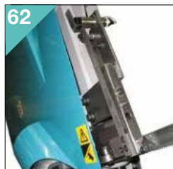
62 Zařízení pro sledování odchylky/přesnosti řezání Device to check the blade squareness/accuracy.
