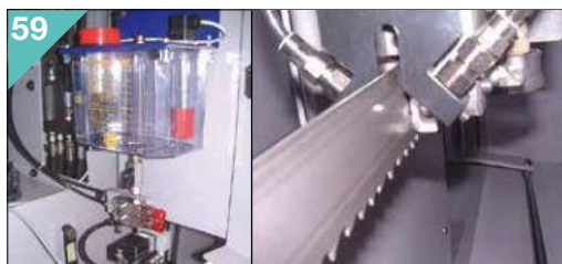
59 Mikro sprejové mazání Micro spray lubrication
