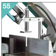
55 XT40002 BS 350 - 400 SHI Vertikální svěrák na výstupu Hydraulic unloading side.
