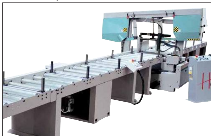
RTR motorizovaný válečkový dopravník jako OPCE / motorized roller table - OPTIONAL
