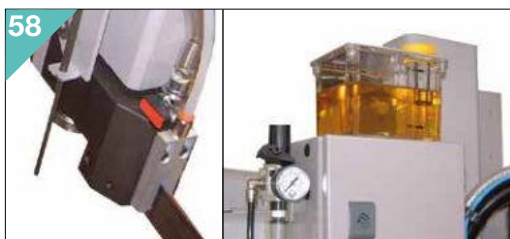
58 Mikro sprejové mazání Micro spray lubrication
