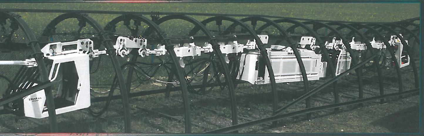
Шахтный подвесной локомотив IMM 120 TD является тяговым средством транспортных составов предназначенных для перевозки материалов и людей в шахтных условиях на монорельсовых подвесных дорогах профиля I 155 при угле наклона 0–30 градусов.
