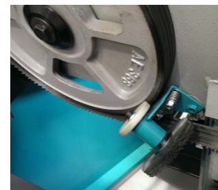
Sklon kol 30°. Menší namáhání pásu v krutu.
