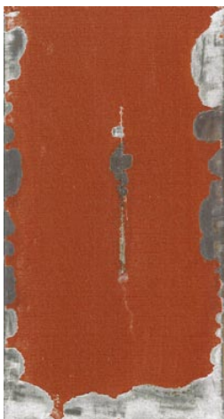
Standardní zinkovaný plech s polyesterovým povlakem
