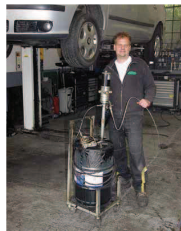
Profesionál se pozná i podle vybavení. Výkonná elektrická pumpa nanese vosk do skrytých míst karoserie lépe než ruční.
