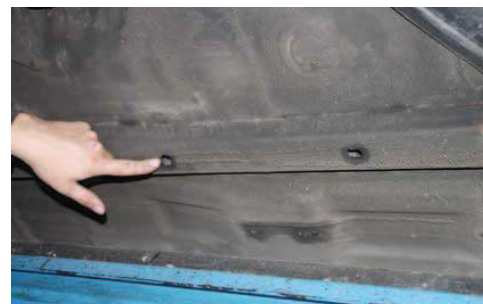
Zatímco v minulosti se na určených místech musely otvory do nosníků vrtat, dnes je stačí najít. Některé jsou kryté zásepky.
