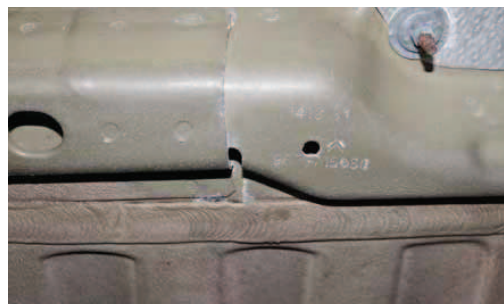
Ukázka odbyté ochrany z výroby, bílé tečky prozrazují počínající korózi. Snímek je z Peugeotu 301, ani francouzské značky dnes nezaručují jistotu.
