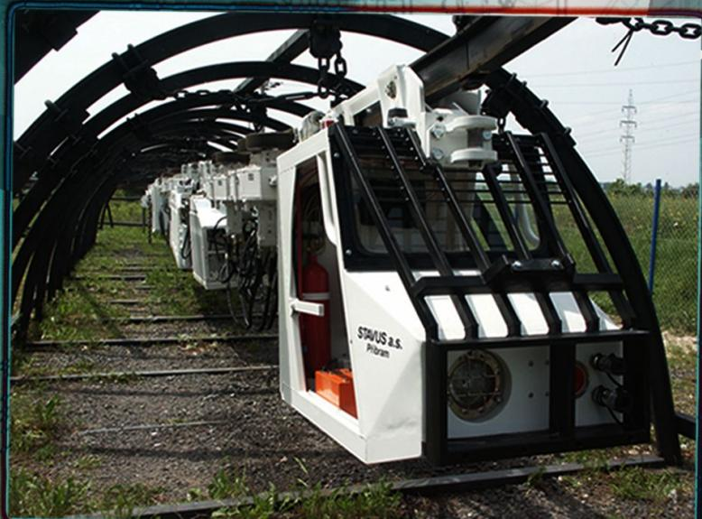
ZÁVĚSNÁ LOKOMOTIVA IMM 100.01 TD je trakční prostředek určený na přepravu vlakové soupravy po jednokolejnicové závěsné dráze profilu I (I 155) schváleného typu v horizontální rovině a úklonech do stoupání, event. klesání 25°. Lokomotiva IMM 100.01 TD je provedena jako několikadílná. Je tvořena motorovou částí, dvěma samostatnými kabinami a případnými samostatnými hnacími jednotkami spojenými navzájem táhly.
