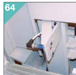
64 Laserová detekce pro automatický zářez začátku tyče / Laser detection for automatic trim cut.
