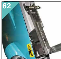
62 Zařízení pro sledování odchyly /přesnosti řezání Device to check the blade squareness/accuracy.
