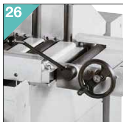
26 RAVTFCR VTF 500 SHI-E Propojení pro výstupní zdvižnou rolnu Connection element for unloading table with lift material roller.
