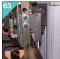
63 Zařízení pro sledování odchyly /přesnosti řezání Device to check the blade squareness/accuracy.
