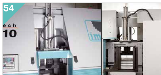
54 AUTOMATICHE SERIE MAXI - AUTOMATIC MAXI SERIES Hydraulické zařízení pro řezání ve svazku Hydraulic device for bundle cutting.
