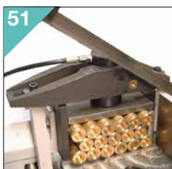
51 Hydraulické zařízení pro řezání ve svazku Hydraulic device for bundle cutting.
