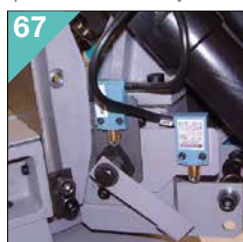
67 000910 RTD RTP Synchronizátor pohybu válečku dopravníku/ rámu. Adapter to synchronize roller table / sawframe motion.
