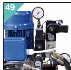
49 Jednostupňová redukce tlaku pro hydraulický svěrák One pressure reducer for hydraulic vice.
