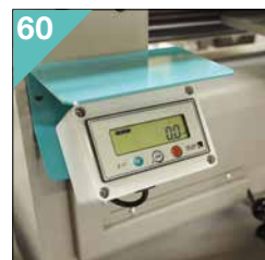
60 Vizualizace řezného úhlu pomocí LCD displeje. Angle digital display.
