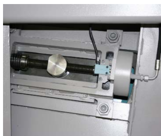
El.mech napínání pásu s CNC kontrolou u všech KS a KTECH pil.
