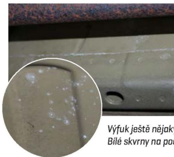
Hlubší než povrchovou korozi vykazují zadní náprava, i ta stojí za ošetření
