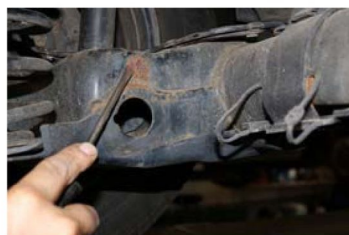
Hlubší než povrchovou korozi vykazují zadní náprava, i ta stojí za ošetření
