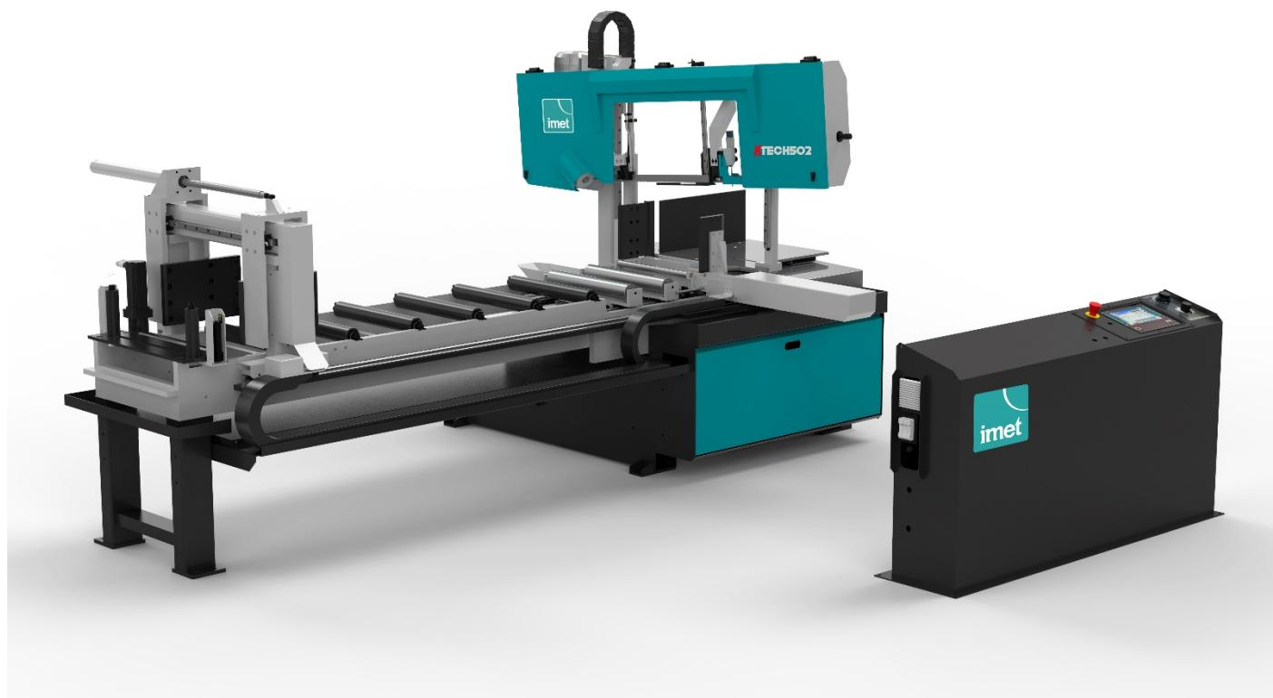
K-Tech 652 F2000 je **automatickou verzí** KS 652, vykonává pohyby na základě lineárního kuličkového šroubového vedení s těžkým zatížením a s hydraulickým posunem pásu řezu, CNC řízením svěráku a natočením. Úhlové řezy **od 60° doleva do 60° doprava** (-30° / 90° / + 30°), řízení s NC podáváním a natočením. Celkem 99 programů s různými délками a úhly, včetně automatického přidání tloušťky pásu.
