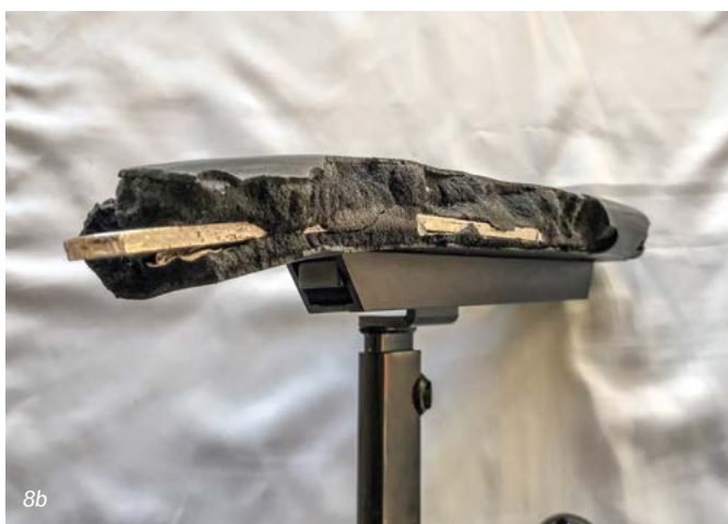
8) Mechanické poškození područky elektrického vozíku
