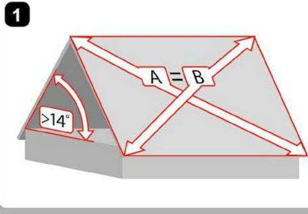
Zkontrolujte, jestli je střecha v pravém úhlu a má spád nejméně 14°. Malé rozdíly je možné vyrovnat šítovým lemováním. V případě velkých nerovností vyměňte poškozené části střechy.
