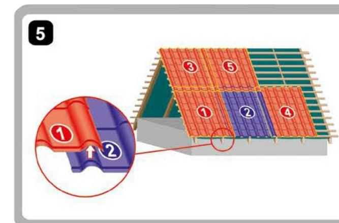
Před montáží krytiny namontujeme závětrné lišty. Krytinu začínáme montovat zleva (netýká se profilů simetrických). Přesné pořadí montáže jednotlivých kusů je znázorněno na obrázku.
