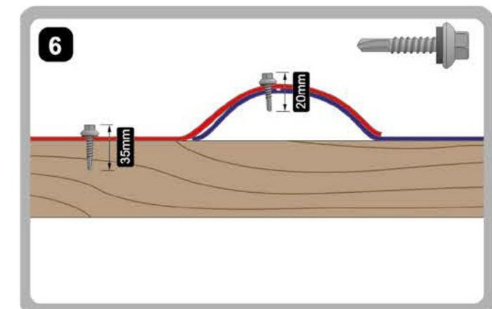
Krytinu šroubujeme do latí vrutů dlouhými 35 mm. Průměrná spotřeba vrutů je 5-8 ks/1m<sup>2</sup>. Aby byly tabule pevně spojené, použijeme kratší vrut, např. 20 mm.
