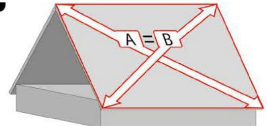
Zkontrolujte, jestli je střecha v pravém úhlu. Malé rozdíly je možné vyrovnat štírovým lemováním. V případě velkých nerovností vyměňte poškozené části střechy.
