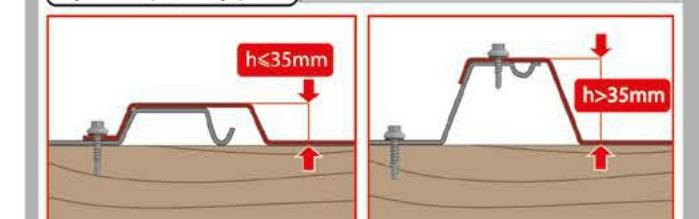
Při montáži další tabule nezapomeňte na přeložení. V případě profilu vyššího než 35 mm spojime dodatečně i na "horní vlně", ve vzdálenosti cca 60 cm.
