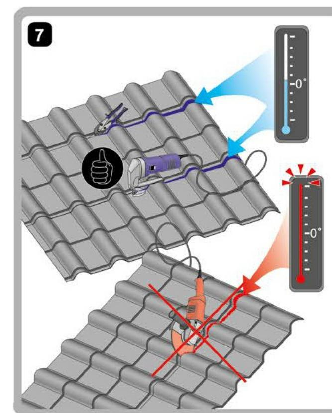
Při práci s plechem se nesmí používat elektrické nářadí, které při práci zahřívá plech.
