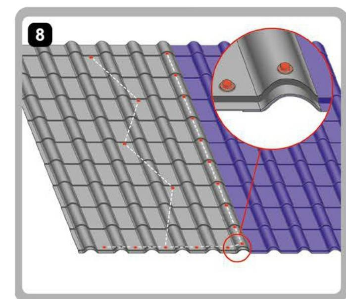
Ukázka přichycení na latě a vytvoření spoje u taškového profilu.
